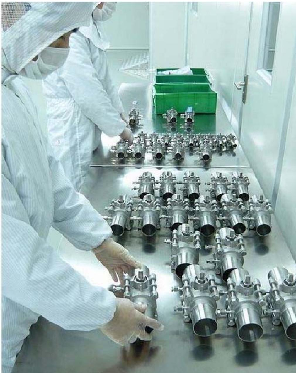
此类阀为全口径或渐缩径设计,较不易在阀内产生压降,适用于需要严密关断的场合,符合工业和国际标准的严格要求.
